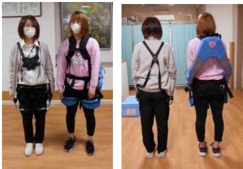
「レイボ エクソスケルトン」は、前屈時に胸部を支えるチェストパッドに内蔵されているエクスジェルが圧力を分散し、回旋動作中も体の動きを妨げずに支え続ける構造になっており、腰骨の部分についているアシスト力 ON/OFF 機能によってスーツの圧力を調整できるので、作業時はON、歩いて移動する時などはOFFにすれば自由に動作ができます。
